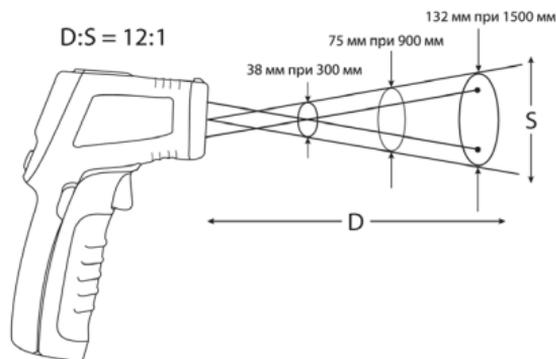
**Выбор горячей точки измерения.** Чтобы выбрать точку измерения, следует навести прибор на область вне пределов зоны измерения, затем, перемещая прибор вверх-вниз, навести его на объект измерения до определения наиболее горячей точки.
