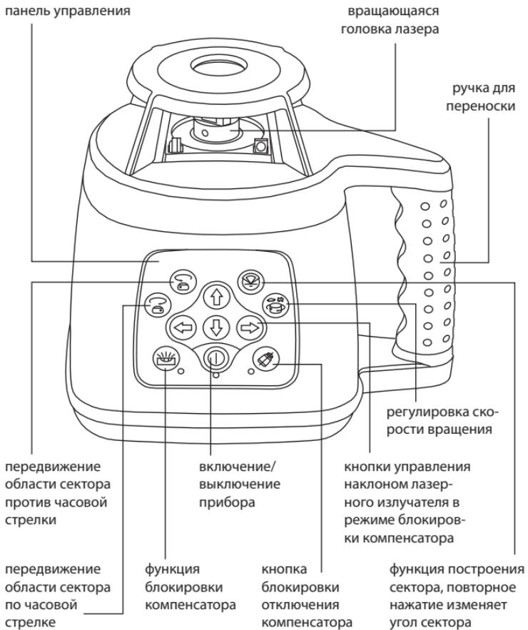
Назначение кнопок на пульте управления полностью аналогично кнопкам панели управления прибором.
